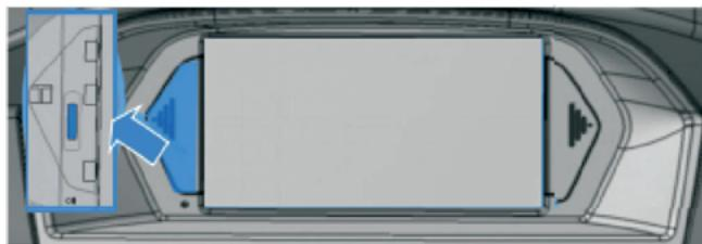
◀ شکل ۹ محل نصب کارت SD
