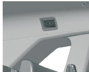
دربیچه هوای عقب راست، بالای شیشه جانبی عقب قرار دارد (شکل‌های ۸۵ و ۸۶).
