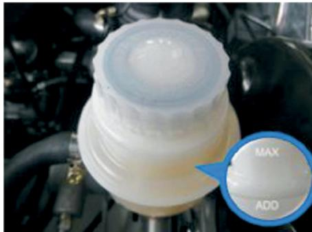
سطح روغن ترمز در مخزن را بازدید کنید (شکل ۱۴۹). این میزان همیشه باید بین ADD (حداقل) و MAX (حداکثر) باشد. در خودروهای راست فرمان، مخزن روغن ترمز طی دوره کوتاهی شدیداً کاهش می‌یابد و زیر علامت با وجود این، اگر سطح روغن ترمز طی دوره کوتاهی شدیداً کاهش می‌یابد و زیر علامت قرار می‌گیرد، ممکن است نشتی وجود داشته باشد. اگر سطح روغن ترمز خیلی پایین باشد، چراغ ترمز روشن می‌شود. در این صورت، باید فوراً به مرکز خدمات مجاز مراجعه کنید تا سیستم ترمز بازدید شود.
