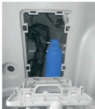
◀ شکل ۱۵۴ محل کپسول آتش‌نشانی
