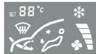
شکل ۷۱ LCD کنترل تهویه مطبوع
