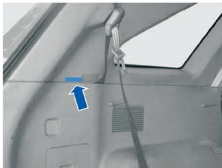
◀ شکل ۱۸۵ محل شماره شناسایی خودرو در کنار درب پشتی روی محافظ پایین
