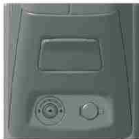
◀ شکل ۸۸ کنترل تهویه مطبوع صندلی عقب
